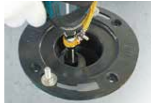
大便器用床フランジの付いた塩ビ管の切断が可能 (TNC-50RS)。
